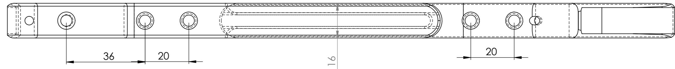
2 perçages en proximal pour vis Ø4,5
