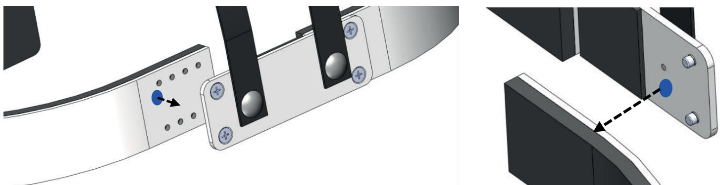
Les vis doivent être placées et serrées selon le schéma ci-dessus. Le cran marqué d'un point bleu sur la pièce 4 correspond au cran marqué d'un point bleu sur la pièce 5.
