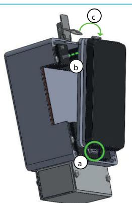
Fig. 3 : Montage de la plaque de compression sur le boîtier
