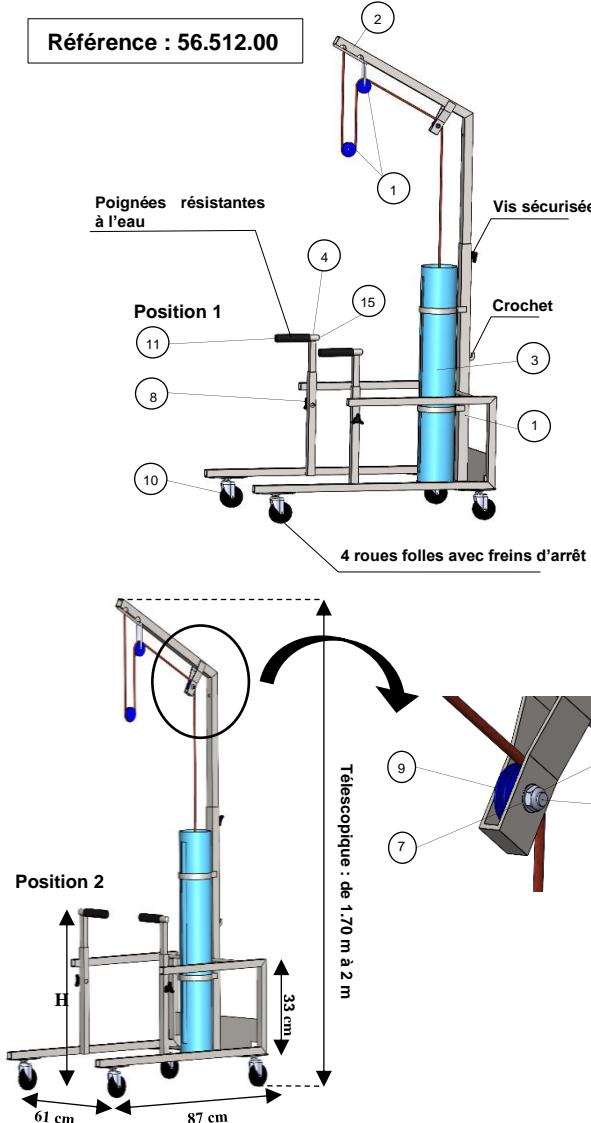
Le dispositif contient deux paires de poignées de taille différente à choisir en fonction de la taille du patient. Les poignées basses possèdent deux positions illustrées ci-dessus. La hauteur H va de 49,5 à 60,5 cm pour les poignées basses et de 71,5 à 90 cm pour les poignées hautes. Les deux poignées doivent être réglées à la même hauteur et arriver au niveau des hanches de l'utilisateur.
