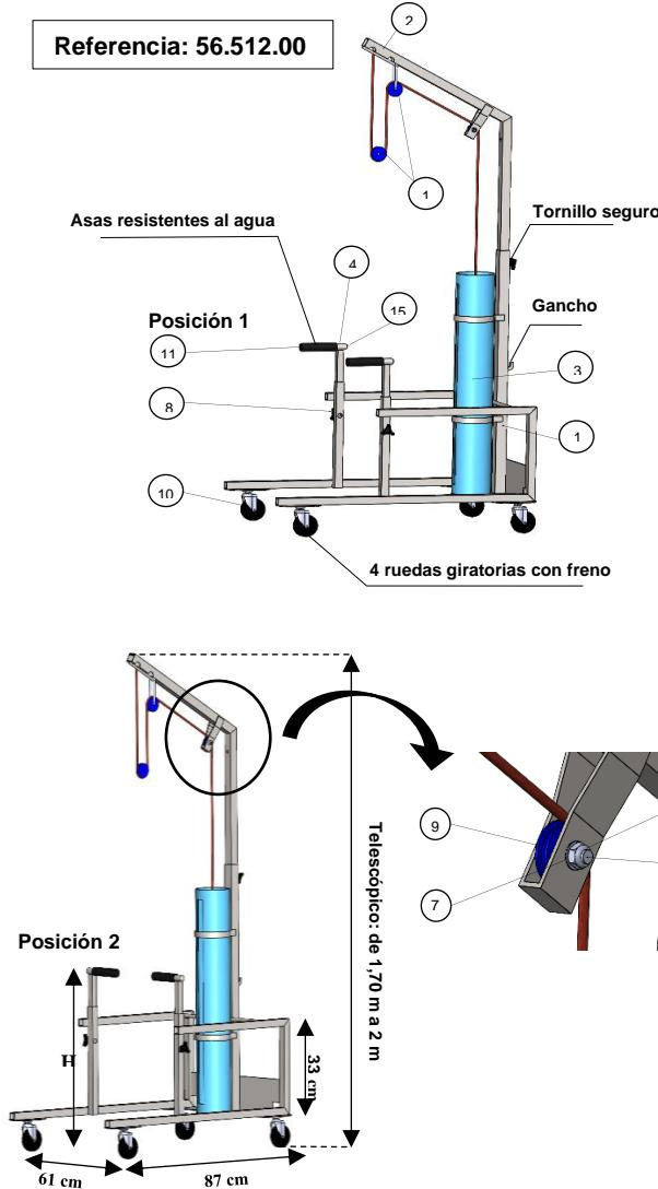
El dispositivo contiene dos pares de asas de diferentes alturas para elegir según la altura del paciente. Las asas bajas ofrecen las dos posiciones que se muestran arriba.
