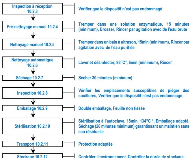
Les consignes fournies par le fabricant du détergent concernant les concentrations et les températures doivent être respectées. En cas de dépassement excessif de ces concentrations et températures, une décoloration ou une corrosion peut se produire sur certains matériaux. Cela peut également être observé en cas de rinçage insuffisant après le nettoyage et/ou la désinfection.
