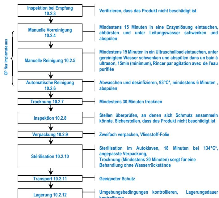
Die Anweisungen des Herstellers des Reinigungsmittels bezüglich der Konzentrationen und Temperaturen müssen eingehalten werden. Bei übermäßigen Abweichungen von diesen Konzentrationen und Temperaturen kann es auf bestimmten Materialien zu einer Verfärbung oder Korrosion kommen. Dies kann ebenso der Fall sein, wenn ein Produkt nach der Reinigung und/oder Desinfektion nicht ausreichend gespült wird.
