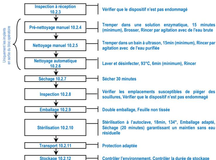
Les consignes fournies par le fabricant du détergent concernant les concentrations et les températures doivent être respectées. En cas de dépassement excessif de ces concentrations et températures, une décoloration ou une corrosion peut se produire sur certains matériaux. Cela peut également être observé en cas de rinçage insuffisant après le nettoyage et/ou la désinfection.
