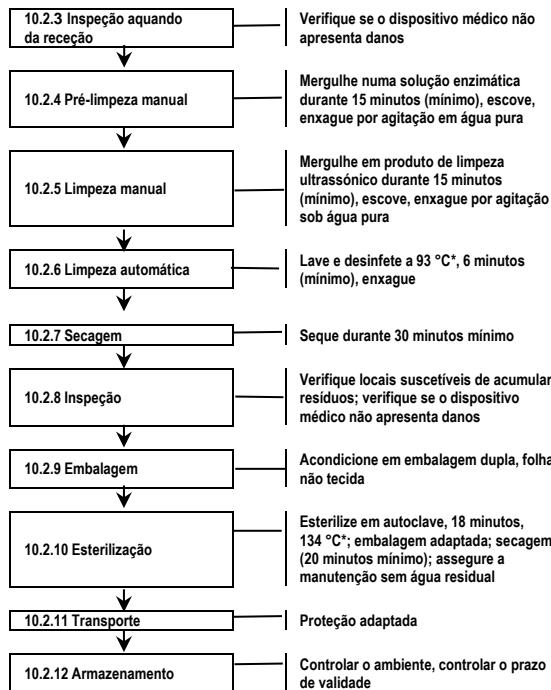
Têm de ser respeitadas as instruções relativas à concentração e temperatura fornecidas pelo fabricante do detergente. Em caso de concentração e temperaturas excessivas, pode surgir descoloração ou corrosão em certos dispositivos. Isto também pode ocorrer em caso de enxaguamento insuficiente após a limpeza e/ou desinfecção.
