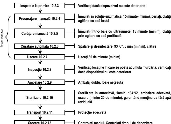
Trebuie respectate instrucțiunile producătorului detergentului cu privire la concentrații și temperaturi. Dacă aceste concentrații și temperaturi sunt depășite excesiv, poate apărea decolorare sau corozione pe anumite materiale. Acest lucru poate fi observat și în cazul clățirii insuficiente după curățare și/sau dezinfecție.
